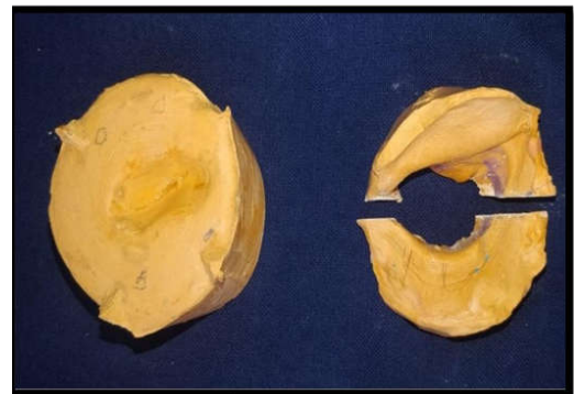
Fig. 7. Mould pour in die stone with sectioned upper part
