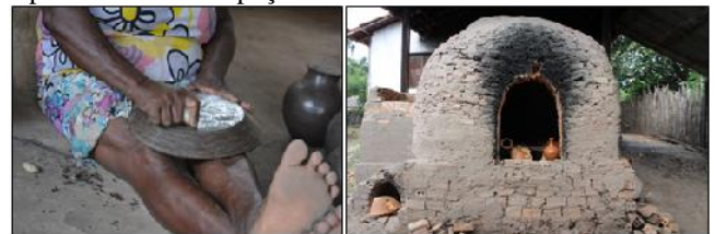
Figura 6a. Polimento das peças cerâmicas após a secagem e antes da queima. Foto: Arkley Bandeira, 2018; Figura 6b- Forno de queima cerâmica, com objetos já queimados em seu interior. Fotos: Autores, 2018
