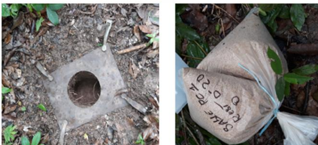
Figure 4. Matériel pour la mise en œuvre de la méthode au sable (a: plaque d'acier; b: sable marin)
